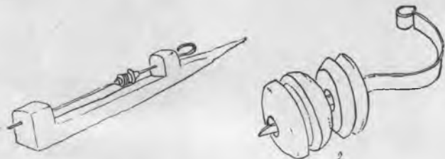
Сл. 8. (1) „бурма“, цев за почетак предења, (2) „бубрег“ кугла са жлебом у који улази „јерган“ (уже)
