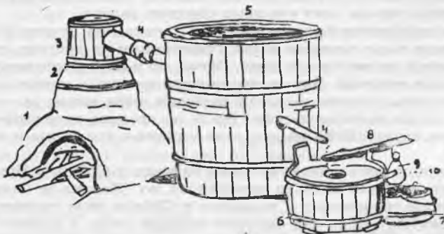
Сл. 36. Награђен казан за печење ракије (Блазнава, Јасеница) (1) банак, (2) казан, (3) капак, (4) лула, (5) табарка, (6) постава, (7) бакрач, (8) претега (9) тиква, (10) цевчица
