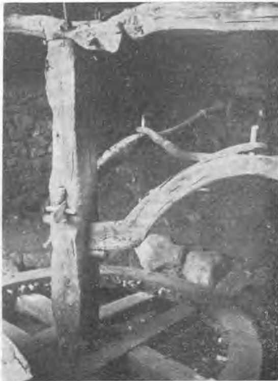
Снимак 7. Начин причвршћивања кола, „потегла“, „поведла“ и „препаса“ за вретено
