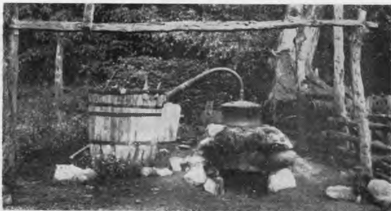
Сл. 37. Казан за печење ракије с капаком и лулсом од бакра (Ново Корито, Тимок)
